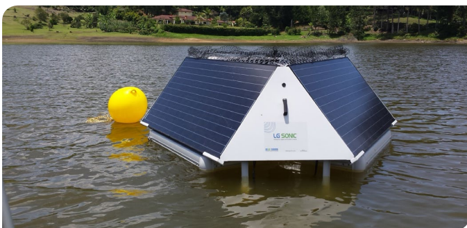
Imagen 1: MPC-Buoy instalada en Embalsa la Fe
