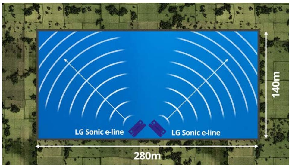
La solución consiste en instalar uno o varios sistemas que transmitan parámetros ultrasónicos específicos en función del tipo de algas.
