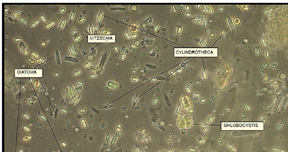
Figura 10- células de algas - agua sin tratar
