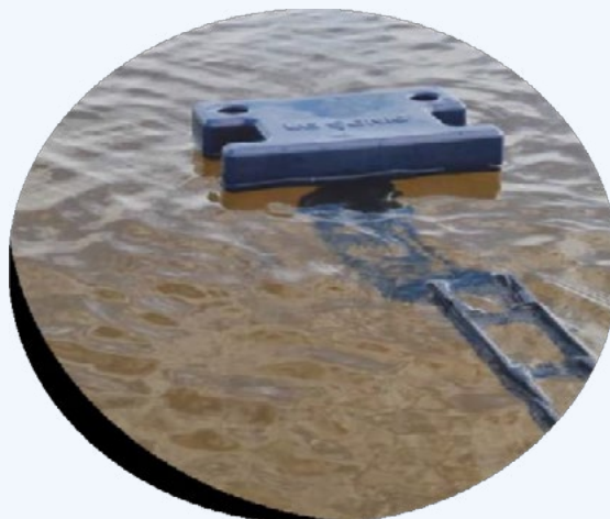
Figura-9- a- montaje del transmisor 4 LG Sonic en el decantador radial b- montaje del transmisor LG Sonic en el estanque de salida de agua
